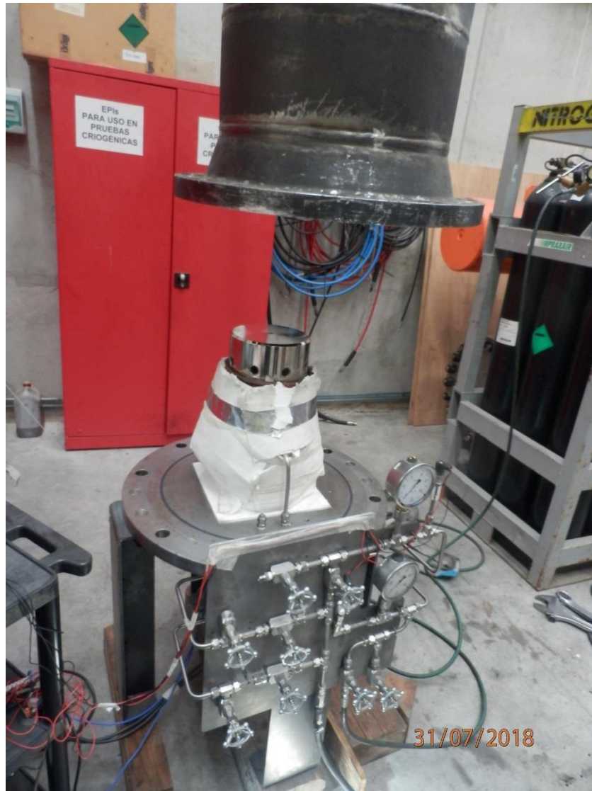
Figure 3. Banc d'essai avec la soupape ASVAD après le test DBA.
